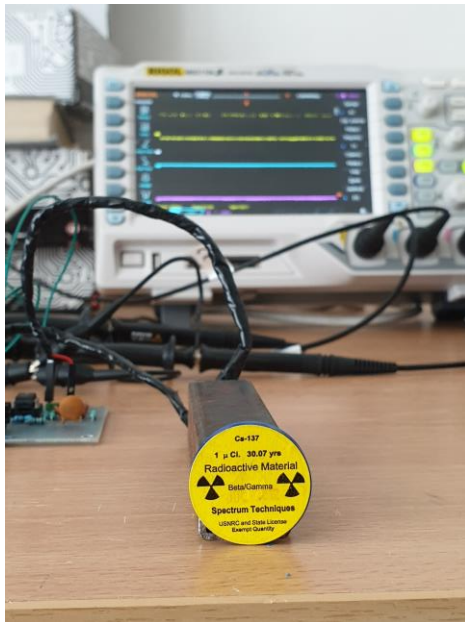
Umieszczenie źródła Cs-137 przed przednim detektorem G-M
