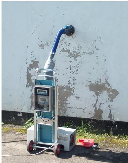
Stacja do poboru aerozoli powietrza z kranów w obiektach 2 i 3 w KSOP w Różanie (prod. CLOR).
