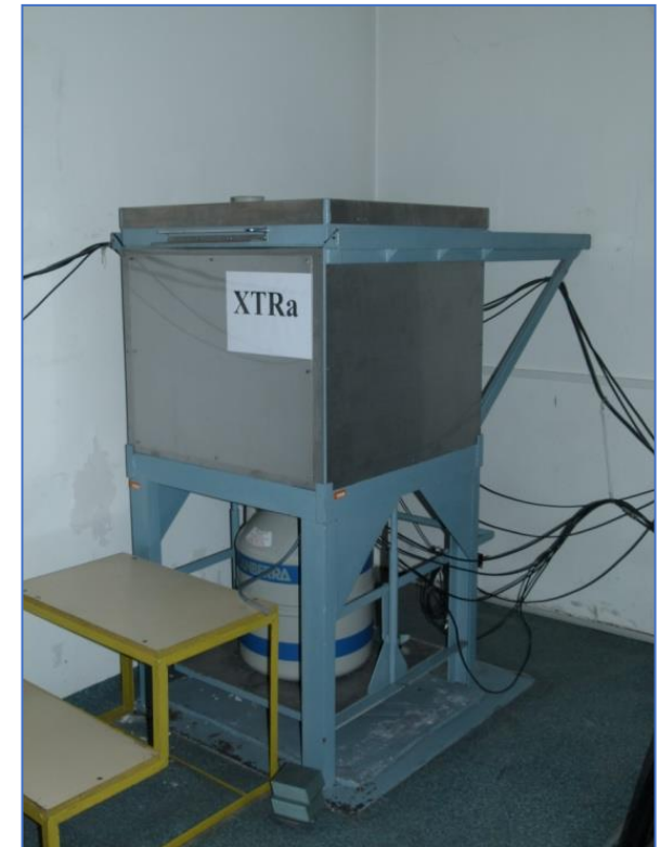
Germanowy detektor półprzewodnikowy HPGe umieszczony w ołowianym domku osłonny
