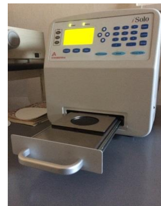
Przenośny, niskotłowy spektrometr \alpha - \beta iSolo firmy Canberra z detektorem krzemowym PIPS
