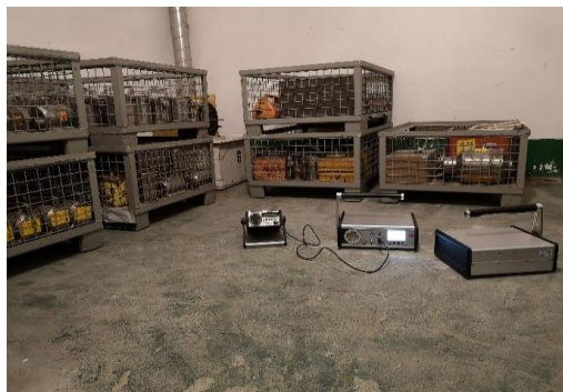
Pomiary przyrządami AlphaGuard i AlphaPm
