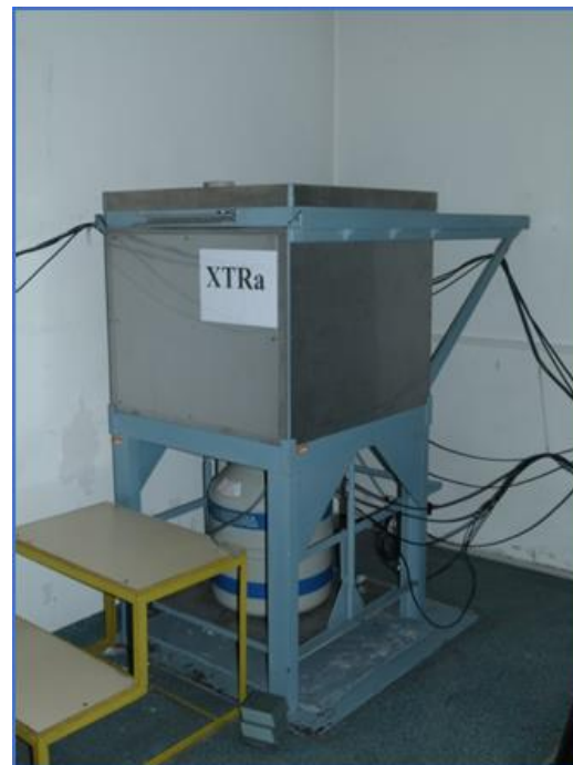
Półprzewodnikowy detektor germanowy HPGe umieszczony w ołowianym domku osłonnym
