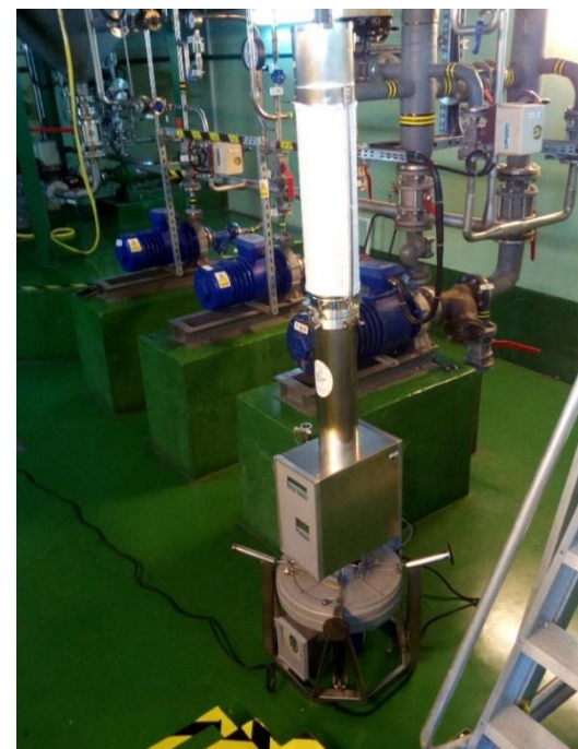
Pobór próbki aerozoli powietrza w miejscu instalacji wyparnej
