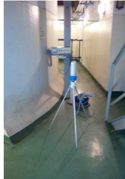
Pobór próbki aerozoli powietrza atmosferycznego w pomieszczeniu zbiornika R3 na poziomie -9,0 m.
