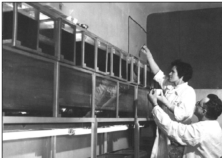
Fig. 20. Akwaria do laboratoryjnych badań hydrobiologicznych nad cezem-137.
