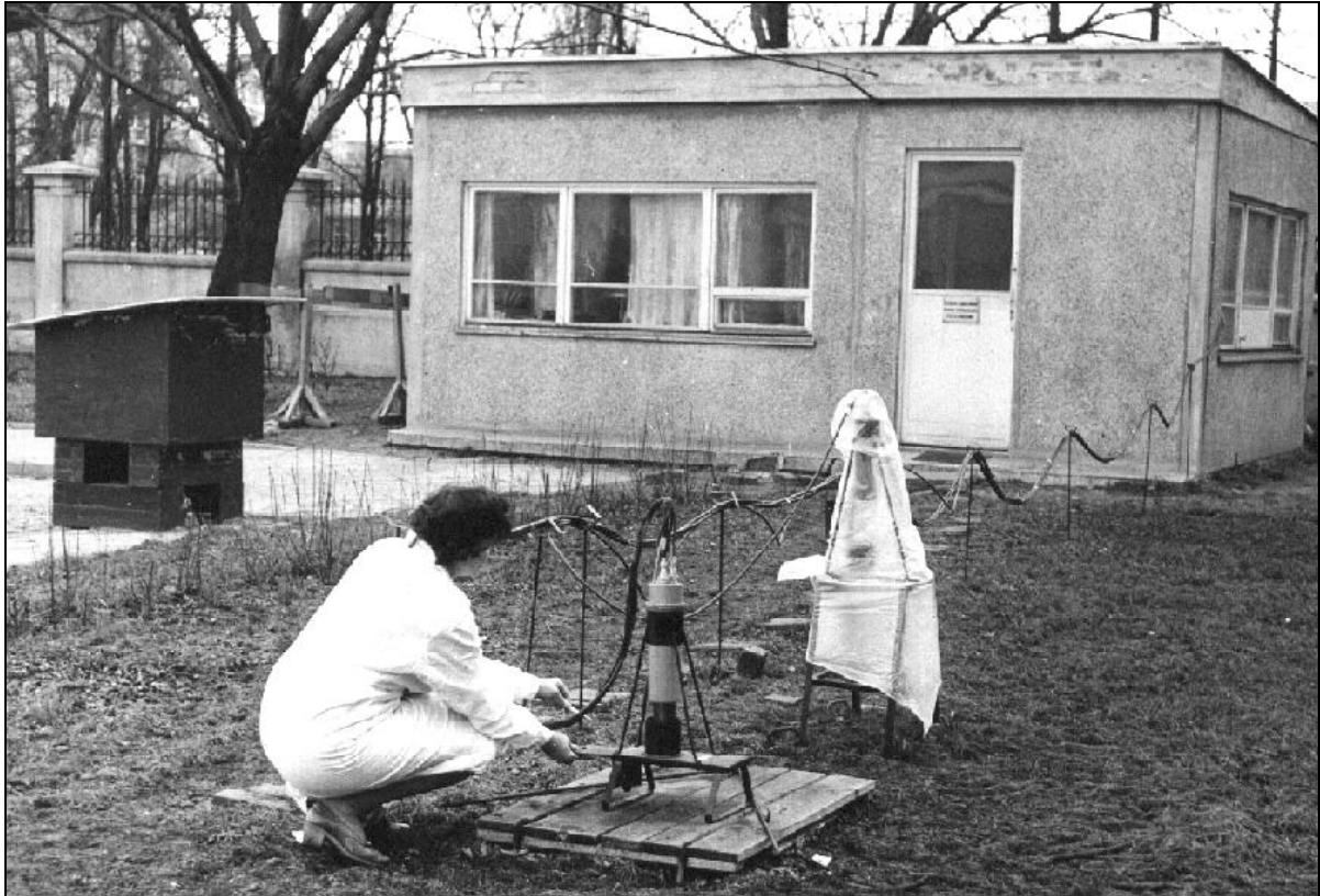
Fig. 27. Mini-laboratorium do badań naturalnego tła promieniowania na terenie filtrów warszawskich.
