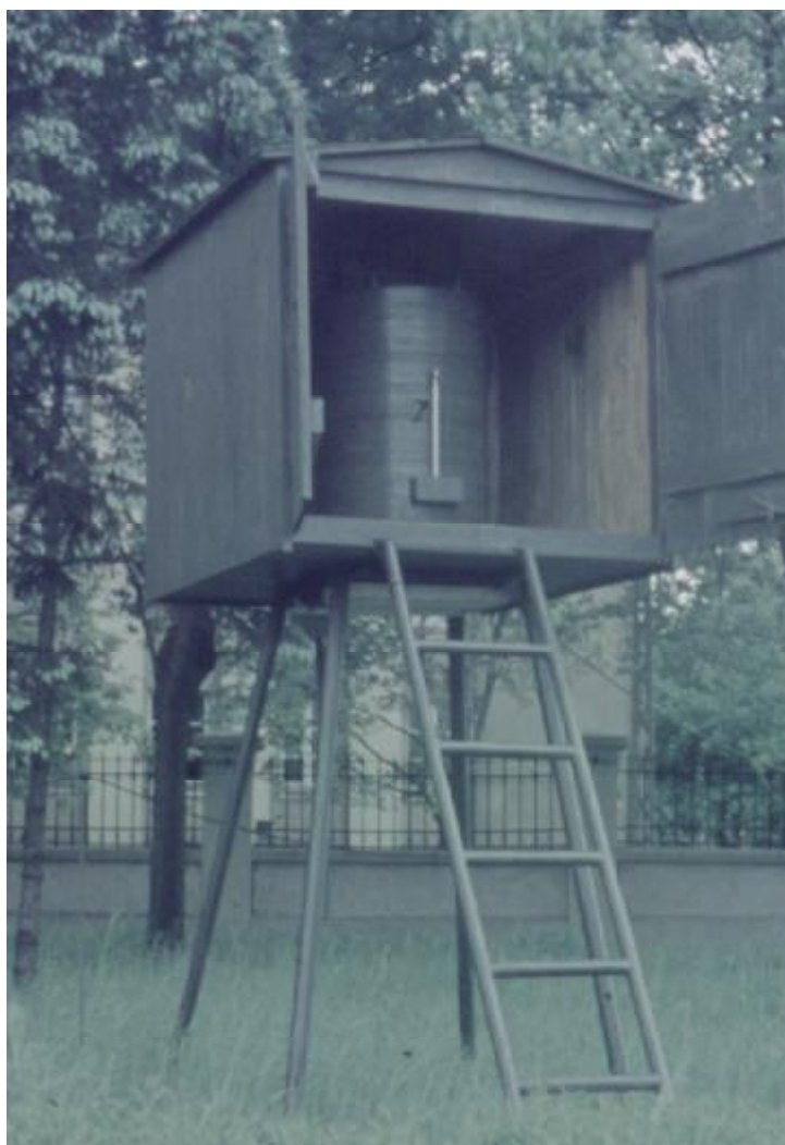
Fig. 23. Osłona detektora promieniowania gamma wykonana z przedwojennych płyt stalowych zdemontowanego statku.
