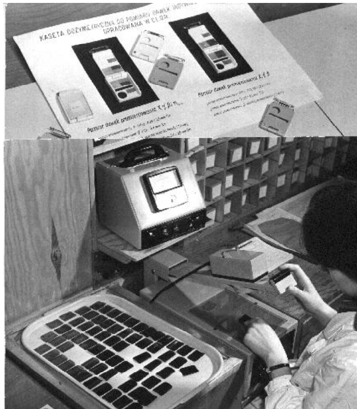
Fig. 3. Indywidualny dozymetr filmowy i odczytywanie wartości ekspozycji.
