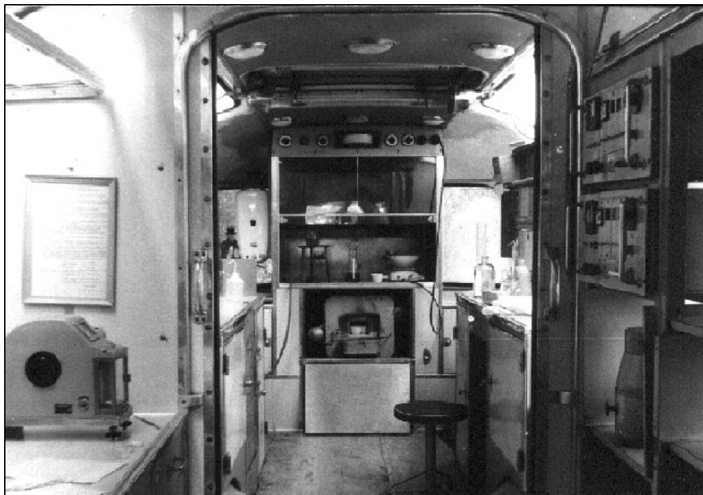
Fig. 17. Wnętrze „Karosy” - część radiochemiczna do przygotowywania próbek.
